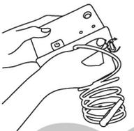
②差し込んだホースの差し込み部分を、時計回りに1/4回転させてカチッと合います。
