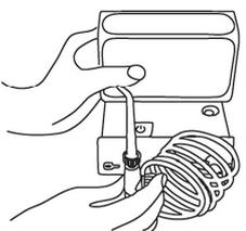
④水槽と本体をジョイント部分を合わせてしっかりと上から押えてはめます。水槽に水を入れます。(冷水はしみますので、その場合はぬるいお湯をご利用下さい)
