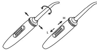
⑤ハンドル上部のノブを回転させて水流を出す方向を変えることができます。また、水圧はハンドルの水圧調節レバーを上下して変えてください。
